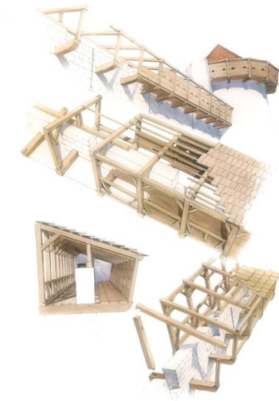
Essai de reconstitution des hourds et de la toiture de la tour des Bourguignons, par Jean Benoît Héron, commande du CMN pour l'expo « Promenons-nous dans le bois » en 2015 © Centre des Monuments Nationaux
